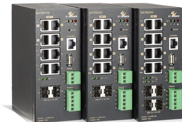
EX78900Gシリーズは最大8ポートのギガビットPoEポートをサポートし、最大90WのPoE電力を提供します。IEEE 802.3afとIEEE 802.3atの規格との互換性を維持し、ポートごとに15W、30W、60W、90Wという多様なPoE電力供給が可能です。最大4ポートの2.5G SFPアップリンクポートを統合し、都市インフラ、交通、セキュリティなどの重要な分野のネットワークに、柔軟性、速度、信頼性を提供するように設計されています。
