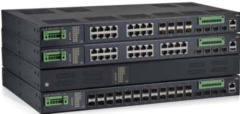
アクセスレイヤー用の1G SFPポートダウンリンクと、アップリンク用の10G SFP+ポートにより、柔軟なネットワーク展開を実現します。
